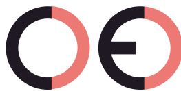
Marca CE falsa (demasiado separados)
